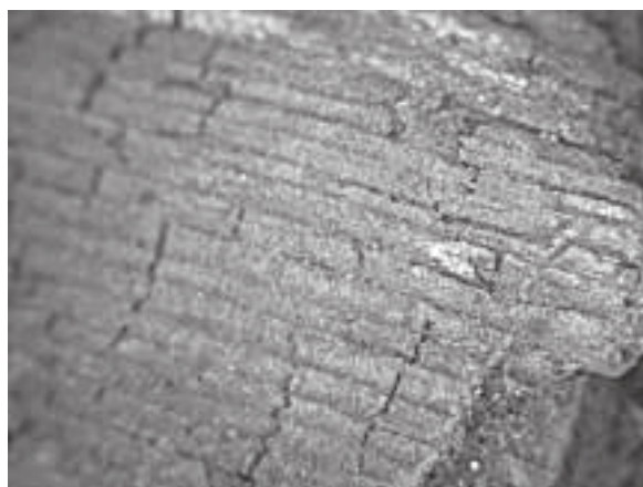
Рис. 13. Трещины и блеск ранней древесины
